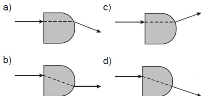
8) (FATEC–SP) Na figura adiante, um raio de luz monocromático se propaga pelo meio “A”, de índice de refração 2,0. Dados  $\text{seno } 37^\circ = 0,60$  e  $\text{seno } 53^\circ = 0,80$ .
